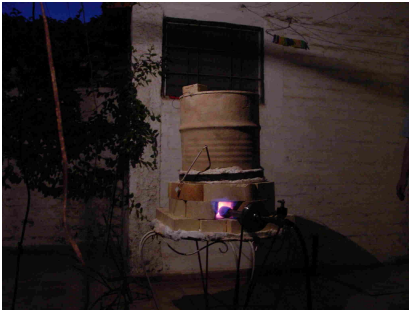
Forno para fundir ferro a crisol aberto. Coque e ar comprimido.
