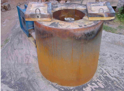
Forno para fundir ferro a crisol aberto. Coque e ar comprimido.
